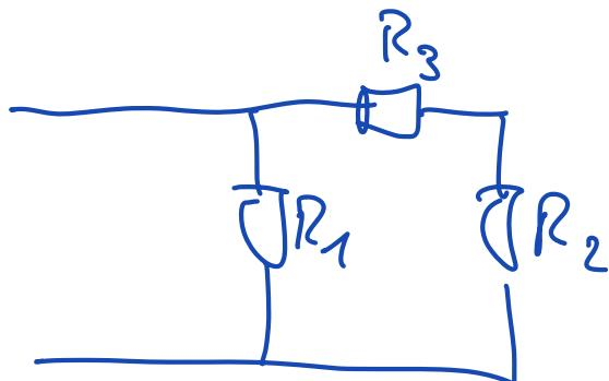
$R_1$  n'est pas en  $\parallel$  avec  $R_2$  !
